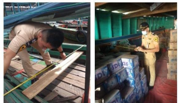
Gambar 3.2. Pengukuran Lebar Kapal di Dermaga 16 Ilir Palembang
